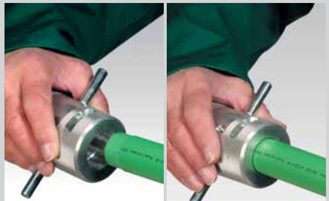
Ljuštenje aluminijskog PP kompozitnog sloja odnosno sloja s barijerom za kisik (potrebno samo kod stabi kompozitne cijevi i aquatherm blue pipe OT cijevi)
