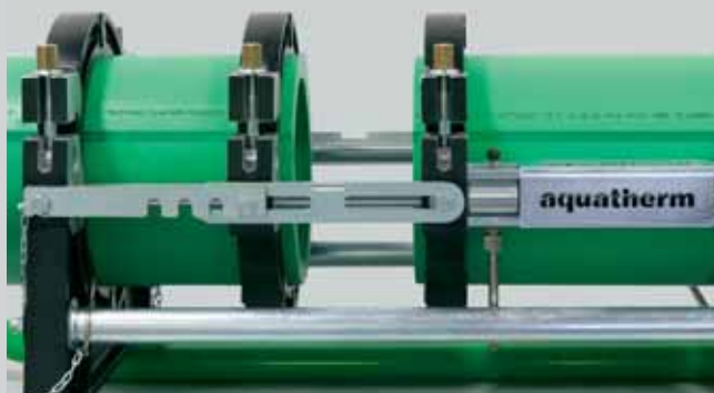
Dijelovi koje treba zavariti fiksiraju se i na odgovarajući način poravnavaju te se koristi glodalica
